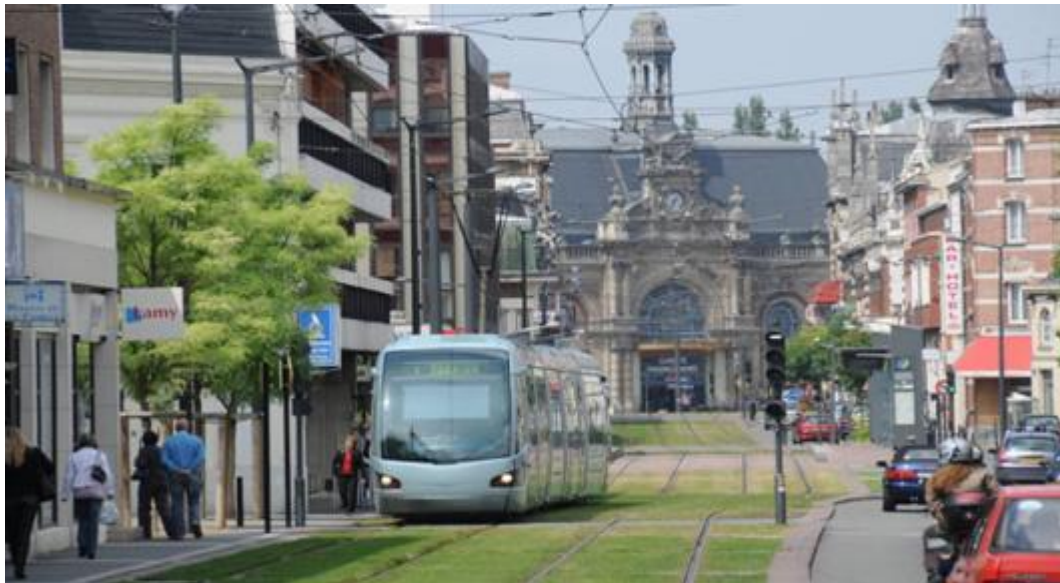
Fransk spårväg i grässpår. Bilden från Trafikförvaltningens Stomnäsplan etapp 1. Foto PG Andersson
