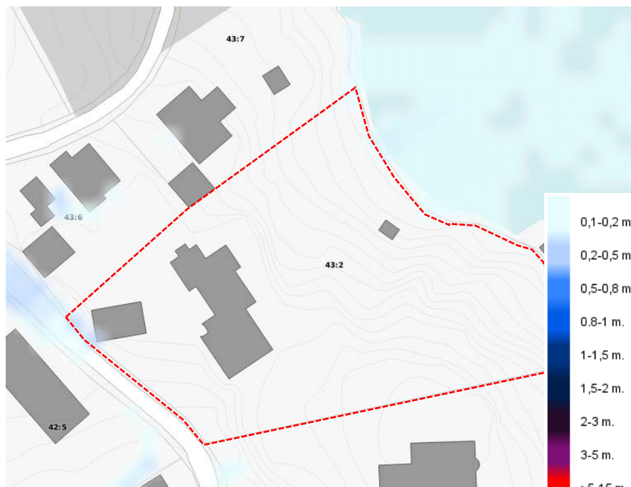
Bilden visar framtida vattendjup vid ett 100-årsregn. Till höger visas vattennivåerna i färgkodning, där ljusblått är lägst och rött är högst. Plangräns i streckad röd linje.
