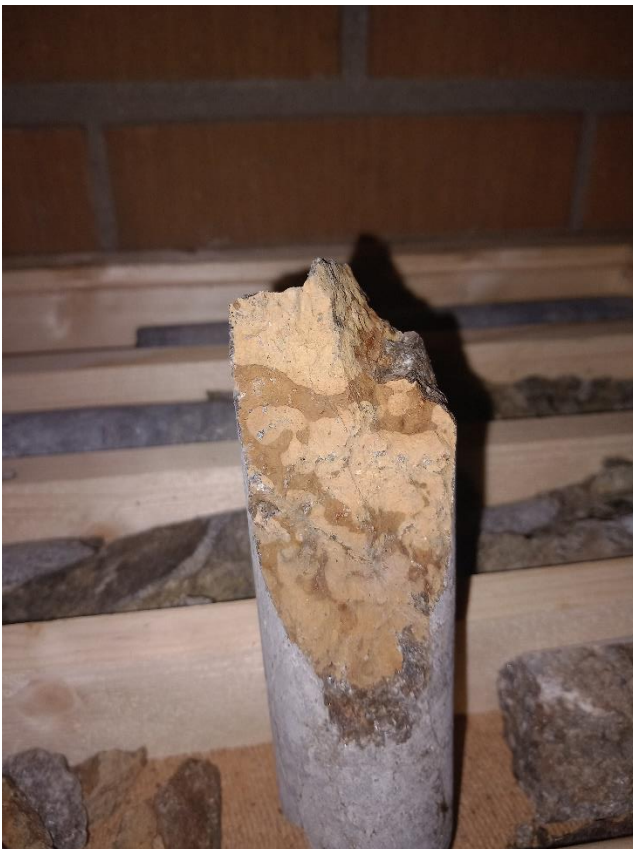
Bild 11: Tydligt oxiderad kärna.
