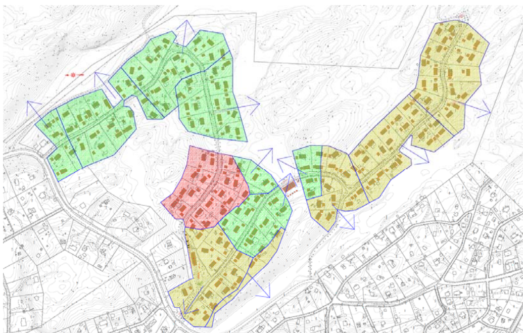
Figur 5 Delavrinningsområden innan avstyckning och genomförda vägarbeten. Rödmarkerat är instängda områden utan naturliga avrinningsvägar. Gult avrinner mot Karbosjön och grönt avrinner mot Rörsundsviken i Saltsjön.
