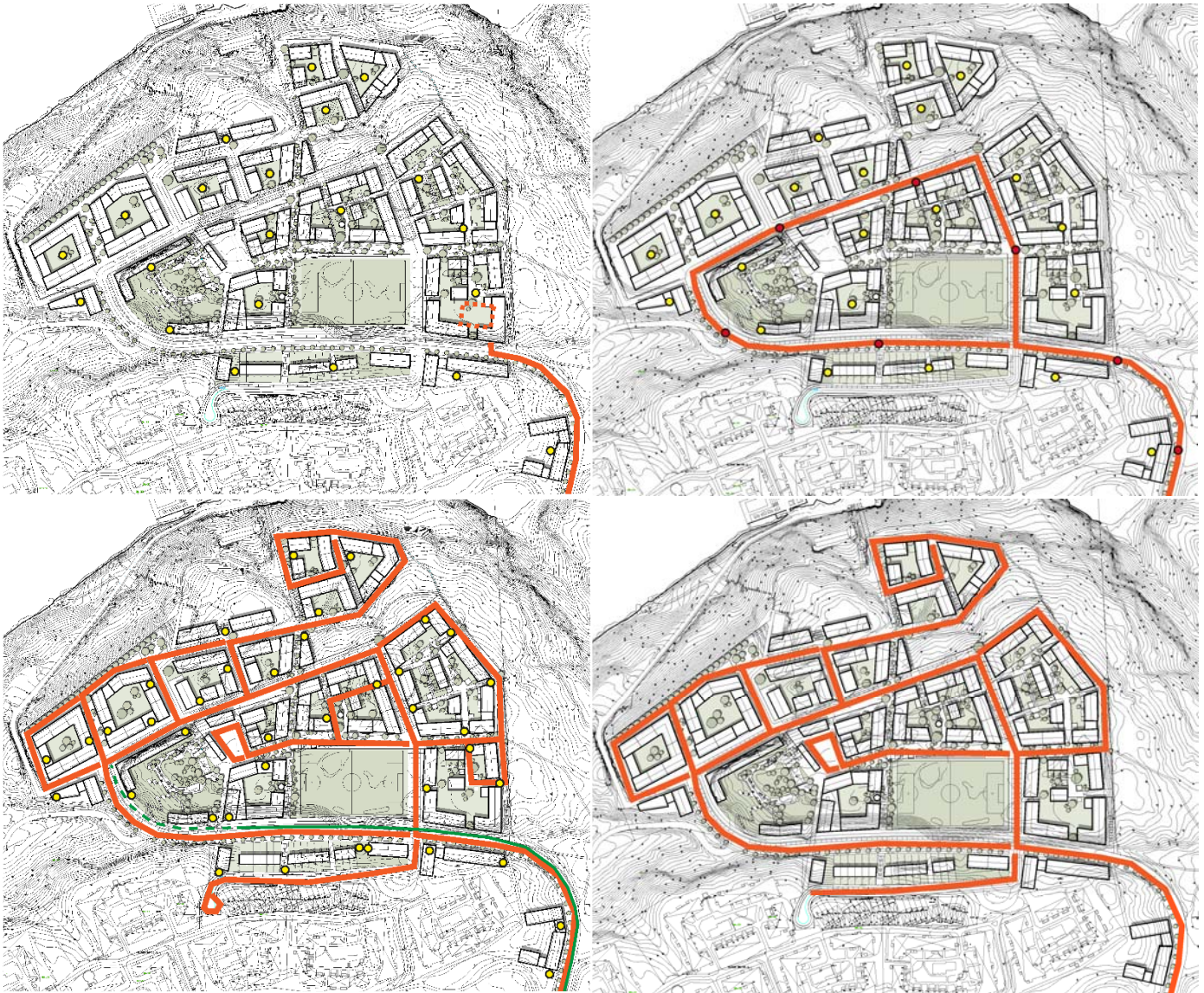
Figur 1. Längst upp till vänster: stationär sopsug. Längst upp till höger: mobil sopusug. Längst ner till vänster: bottentömmande behållare. Längst ner till höger: avfallsutrymmen. Orange linje markerar flöden för tung trafik. Grön streckad linje visa var planerad cykelväg inte är möjlig. Gula prickar markerar avfallsnedkast.
