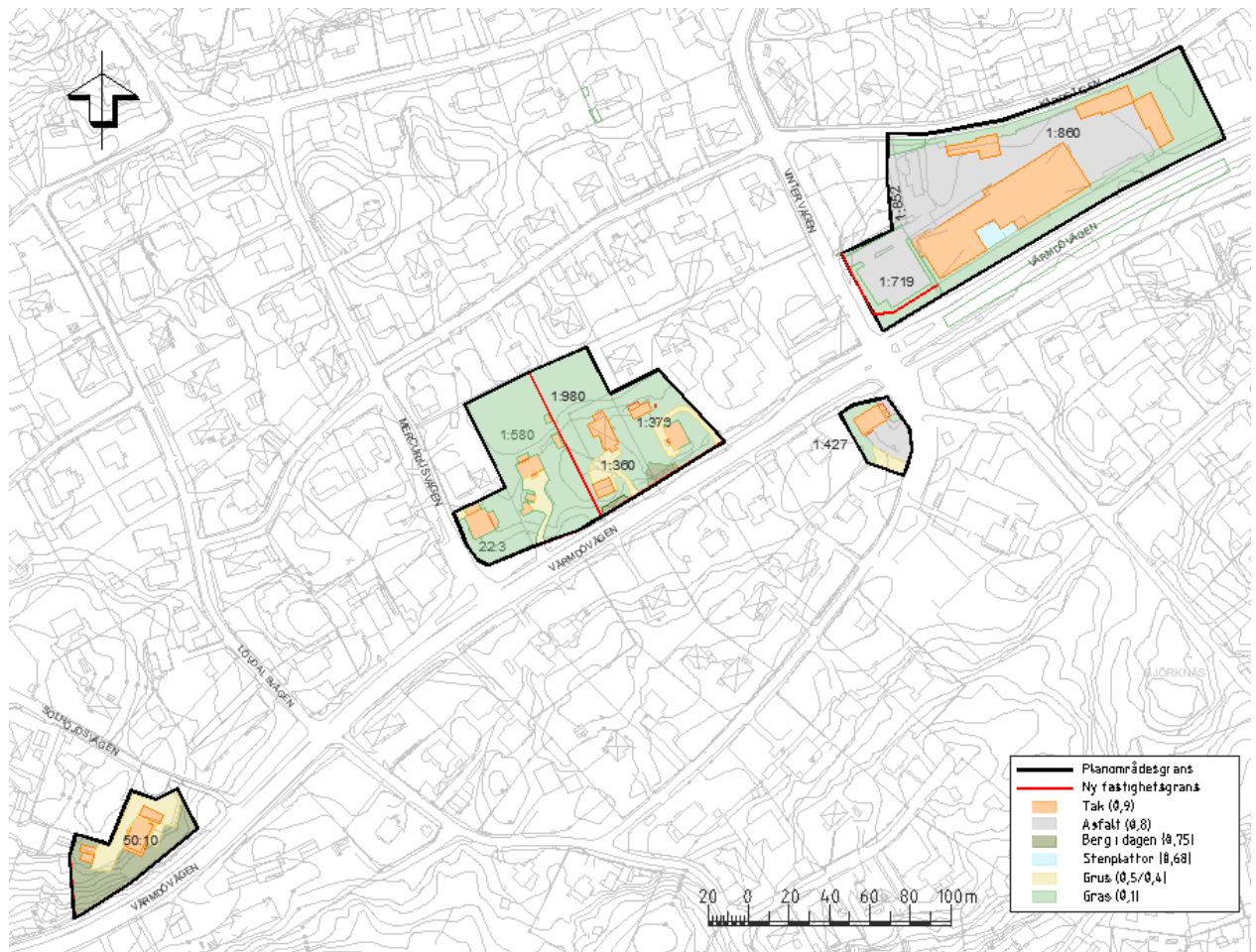
Figur 2-1. Befintlig markanvändning. Avrinningskoefficienter för respektive markanvändning inom parentes. Siffrorna på tomterna är fastighetsnummer, vilka alla föregås av Björknäs
