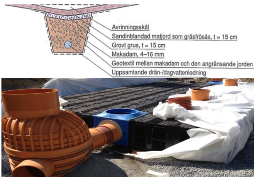
Figur 5-5. Över: Illustration över hur ett krossmagasin kan se ut (Svenskt Vatten, 2011). Under: Sammankopplade dagvattenkassetter (Svenska Bostäder, 2014)
