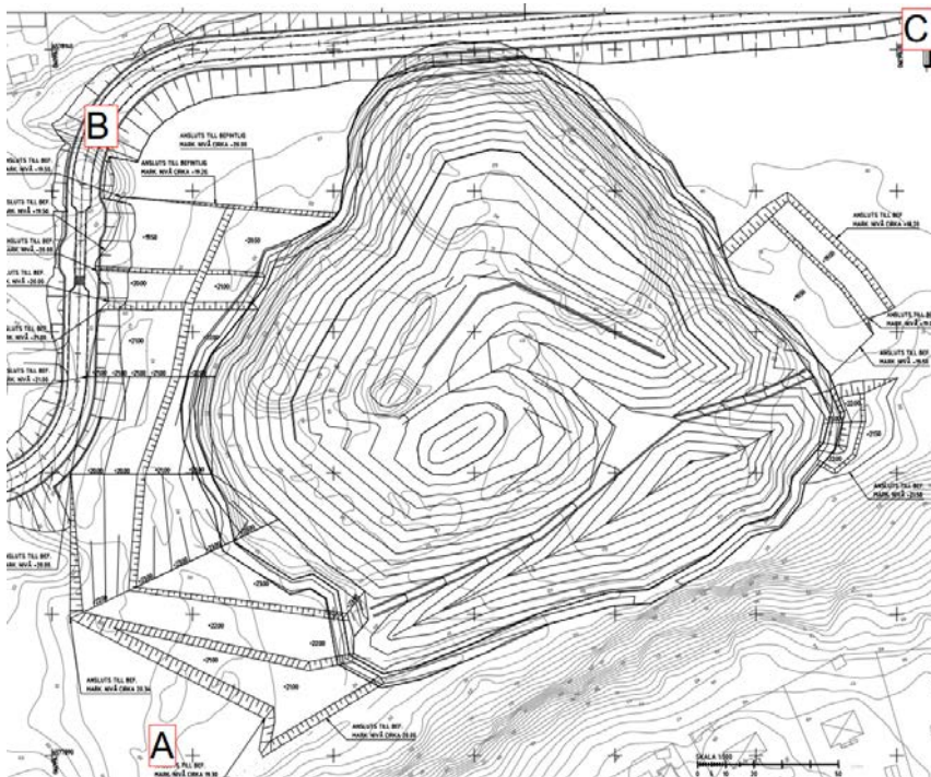
Figur 1: Områden som beskrivs i text om topografi och grundvatten. Jordtippen är illustrerad som den är tänkt efter genomförd sluttäckning. Illustrerad väg anser den planerade nya vägen.
