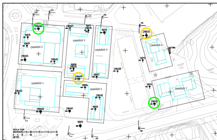
Figur 10. Provtagningspunkter (gult/ grönt) utförda inom miljöundersökningen, 2021. Provtagningspunkter i gult överskrider riktvärdet för KM, provtagningspunkter i grönt underskrider KM.
