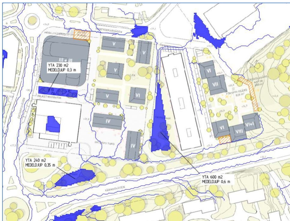
Figur 24 Simulering i Scalgo Live av föreslagen ny höjdsättning av marken. Blåa områden visar var vatten samlas vid ett klimatanpassat 100-års regn och blåa linjer visar flödesvägar. Riskområden vid garagenedfarter och vid förskolan markeras som orangea områden.
