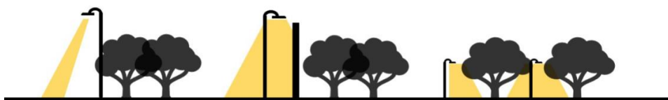
Figur 4 Lampor som kan riktas och bara lysa upp det som är avsett minskar mängden onödigt ljus. Samma effekt kan uppnås genom avskärmning eller genom att låta lampor placeras på lägre höjd
