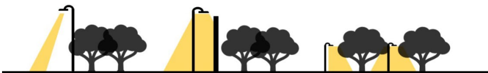
Figur 5 Lampor som kan riktas och bara lysa upp det som är avsett (exempelvis vägbanan) minskar mängden onödigt ljus. Samma effekt kan uppnås genom avskärmning eller genom att låta lampor placeras på lägre höjd
