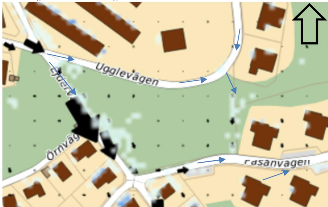
Figur 13. Förstorad vy av detaljplaneområdet hämtat från Nacka Stads Skyfallsanalys för ett 100-års regn med klimatfaktor 1,2. Blå och svarta pilar visar ytliga flödesvägar baserade på en topografisk analys.
