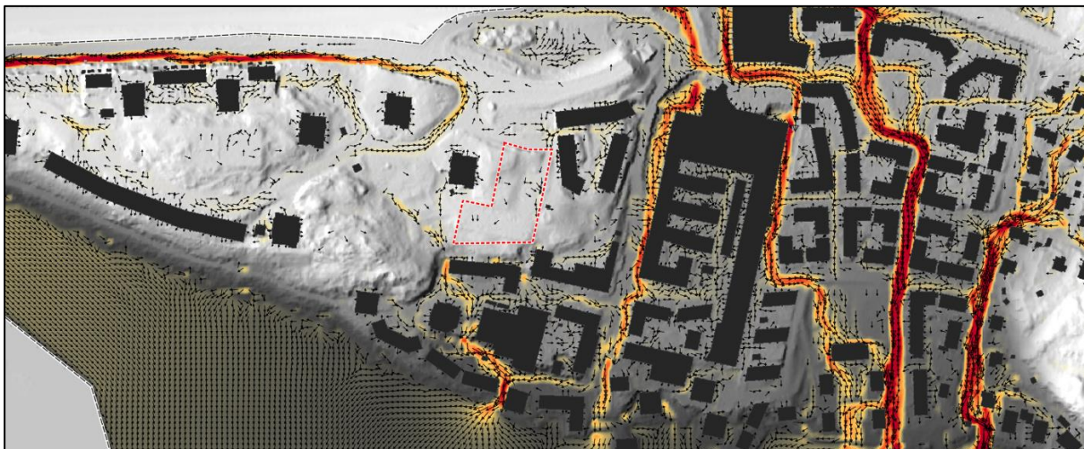
Figur 3-7. Befintliga flödesvägar och maximalt flöde, röd färg = flöde större än 0,2 \text{ m}^3/\text{s}/\text{m} . Röd streckat område motsvarar utredningsområdet.
