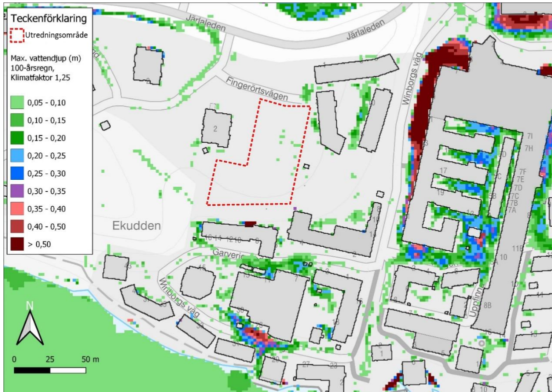
Figur 3-2. Maximalt vattendjup i anslutning utredningsområdet, befintlig situation (scenario 1).
