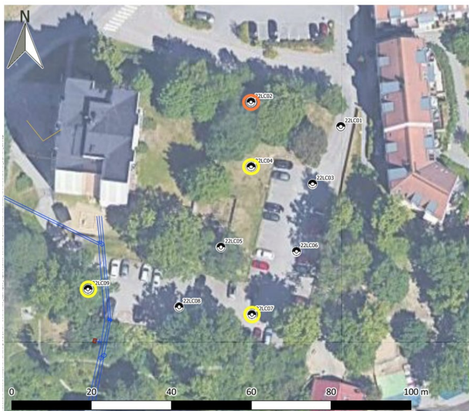
Figur 17 Provtagningspunkter Liljemark, 2023. Orange markering visar på förekomst av halter över MKM, gul markering visar förekomst över KM.
