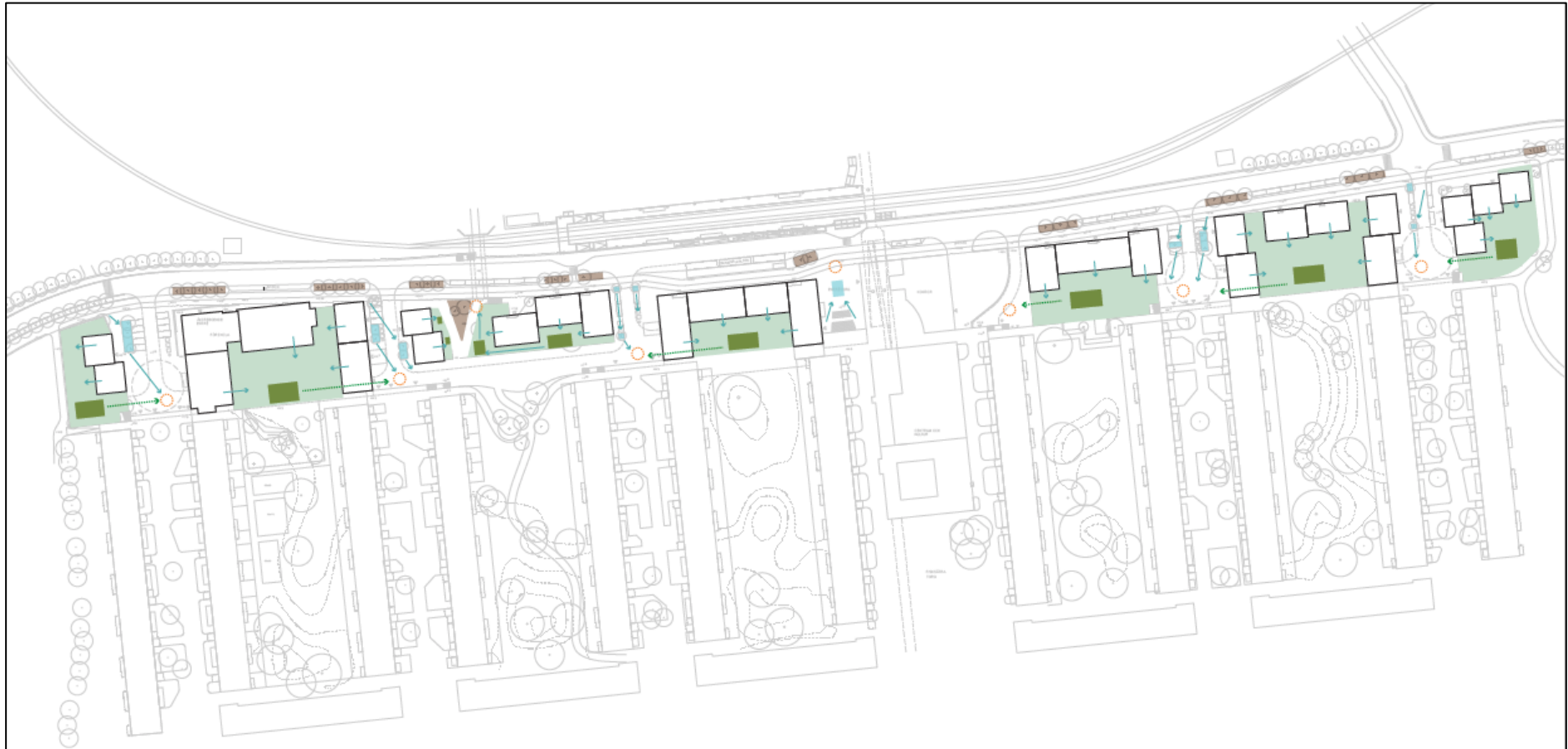
Figur 5-2. Principskiss med ungefärliga placeringar av föreslagna dagvattenhantering (Mandaworks, 2017-09-18). Gröna pilar visar förslag på hur dagvatten leds på hårdgjorda ytor. Gröna ytor symboliserar placering av regnbäddar på kvartersmark, blå ytor växtbäddar med skelettjord och trädplanteringar på kvartersmark och bruna ytor placering av växtbäddar med skelettjord och trädplanteringar på trottoarer på allmän platsmark längs med Fisksätravägen. Anslutning till ledningsnät föreslås vid röda ringar.
