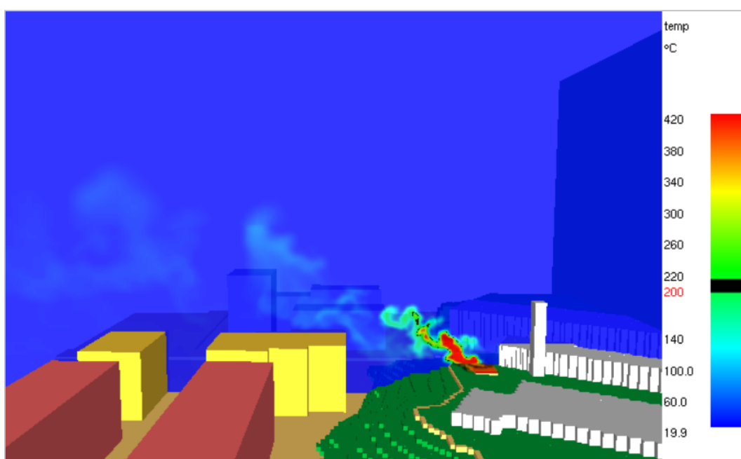
Figur 22. Flamman lutar mot fasaden men når inte fram [180 s]. Fasaden är 35 m bort.
