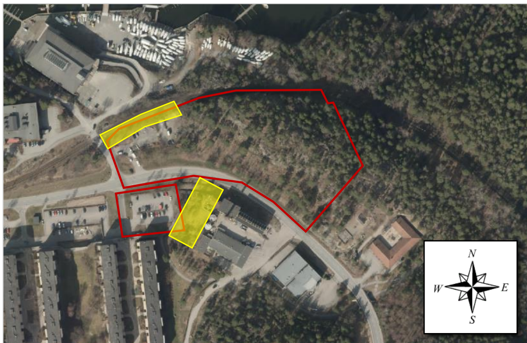
Figur 11. Gul markering indikerar ungefärlig position av bebyggelsefritt skyddsavstånd från Saltsjöbanan respektive i närheten av oljecisternerna.
