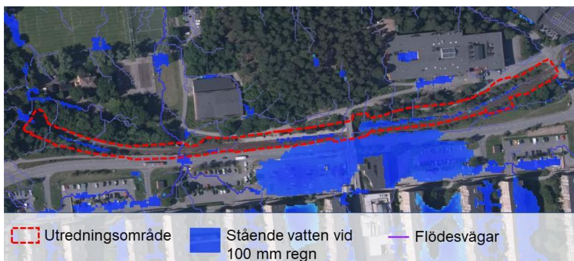
Figur 11. En översiktlig översvämningsskartering (SCALGO, 2019) utifrån ett dimensionerande 100-årsregn under 12 timmar, motsvarande 100 mm nederbörd. Det stående vattnet har en blå färgskala där mörkare blå innebär ett större vattendjup. Flödesvägarna för den ytliga avrinningen har en lila färgskala där mörkare lila innebär större flöden.
