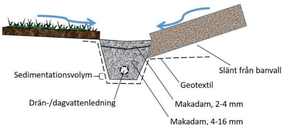
Figur 18. Exempel på utformning av makadamdike som angränsar till banvall.
