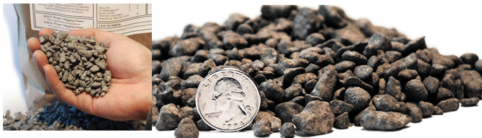
Figur 2: AquaBlok är som ett grus innan det kommer i kontakt med vatten.
