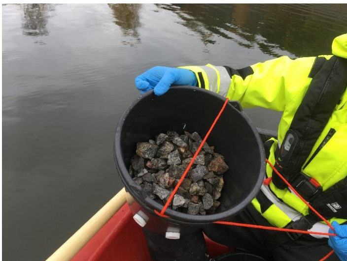
Figur 8-4 För att hålla provtagarna på plats fylldes hinkarna med singel som tyngd.
