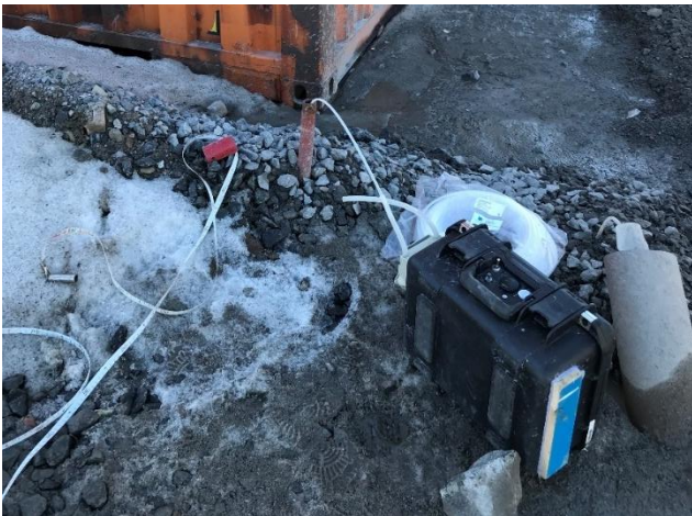
Figur 6-4 Peristaltisk pump samt klucklod vid ett av de djupa rören förstörd foderörsinstallation syns till höger i bild.
