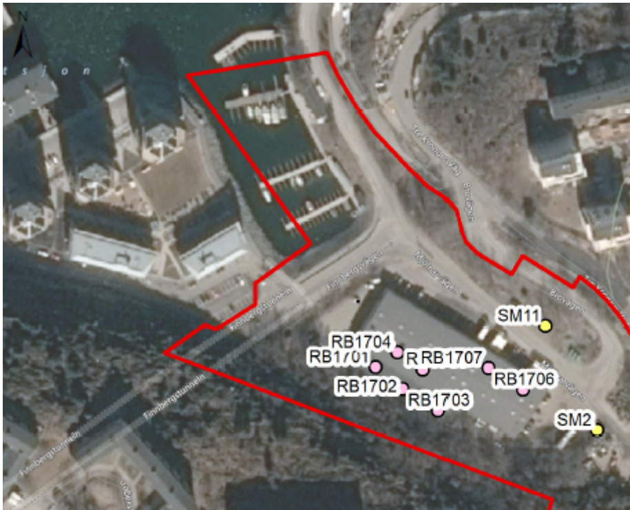
Figur 4-4 Installation av grundvattenrör inomhus. Rören är döpta RB1701-RB1707.
