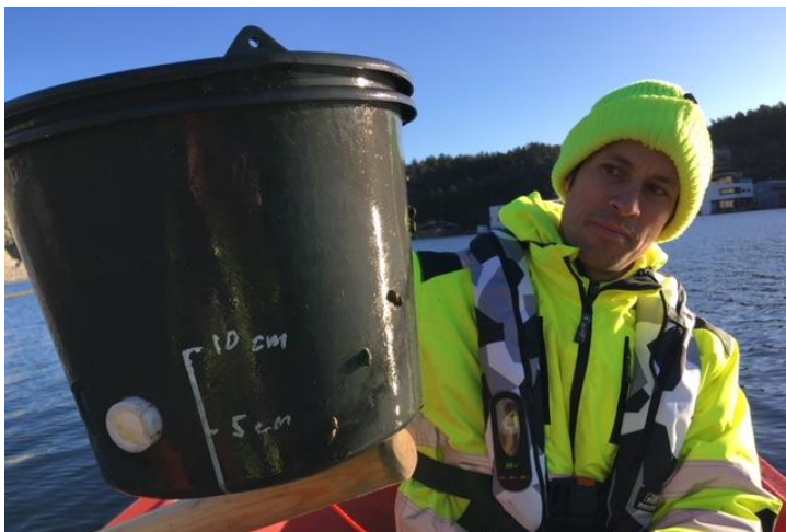
Figur 8-3 Hink för DGT-provtagning. Hinken markerades med 5 respektive 6 cm från botten.
