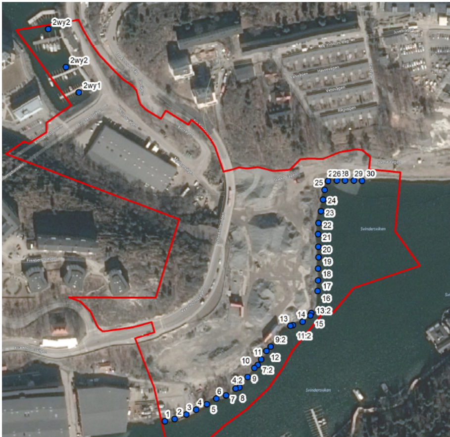
Figur 8-1 Provpunkter för ytvattenprovtagning med teleskoparm. För större bild, se Bilaga 2. Karta © Lantmäteriet
