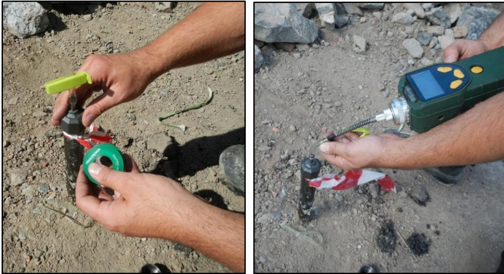
Figur 10-3 Adapter installerad på sondstål utomhus, och tätas inför fältprovtagning med påsklämma. Sedan utförs fältanalys (PID) i adaptern.
