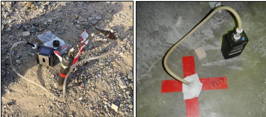
Figur 10-2 Pumpad provtagning utomhus samt i byggnad, DP Gäddviken.
