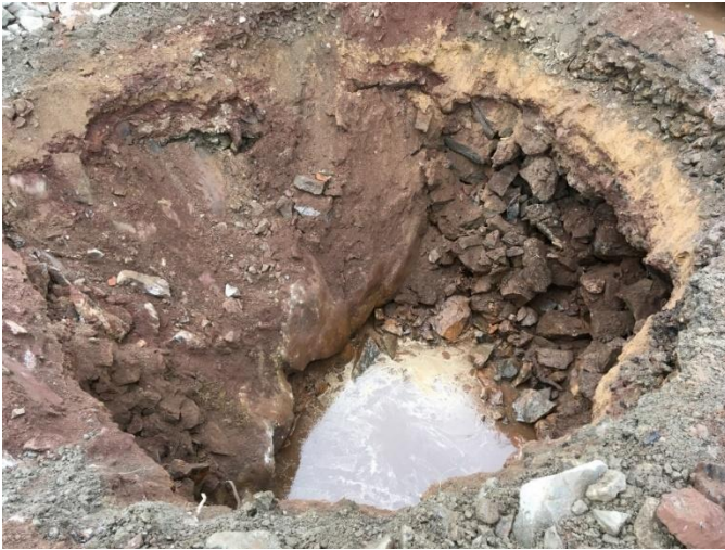
Figur 4-8 Provgrop 1w3. Större block eller berggrund i bortre kant av grop. Fyllnadsmassor påverkade av lila kisaska.
