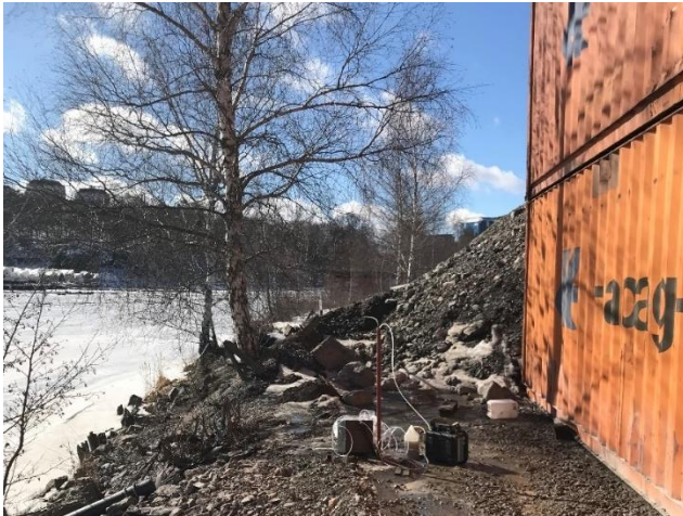
Figur 6-3 Provtagning av grundvatten har skett med peristaltisk pump.
