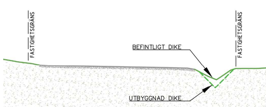
Figur 6. Exempel på utökad dikesektion för omhändertagande av dagvatten.
