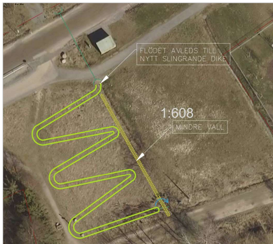
Figur 9. Skiss i plan på slingrande dike i fördröjningsyta A1.
