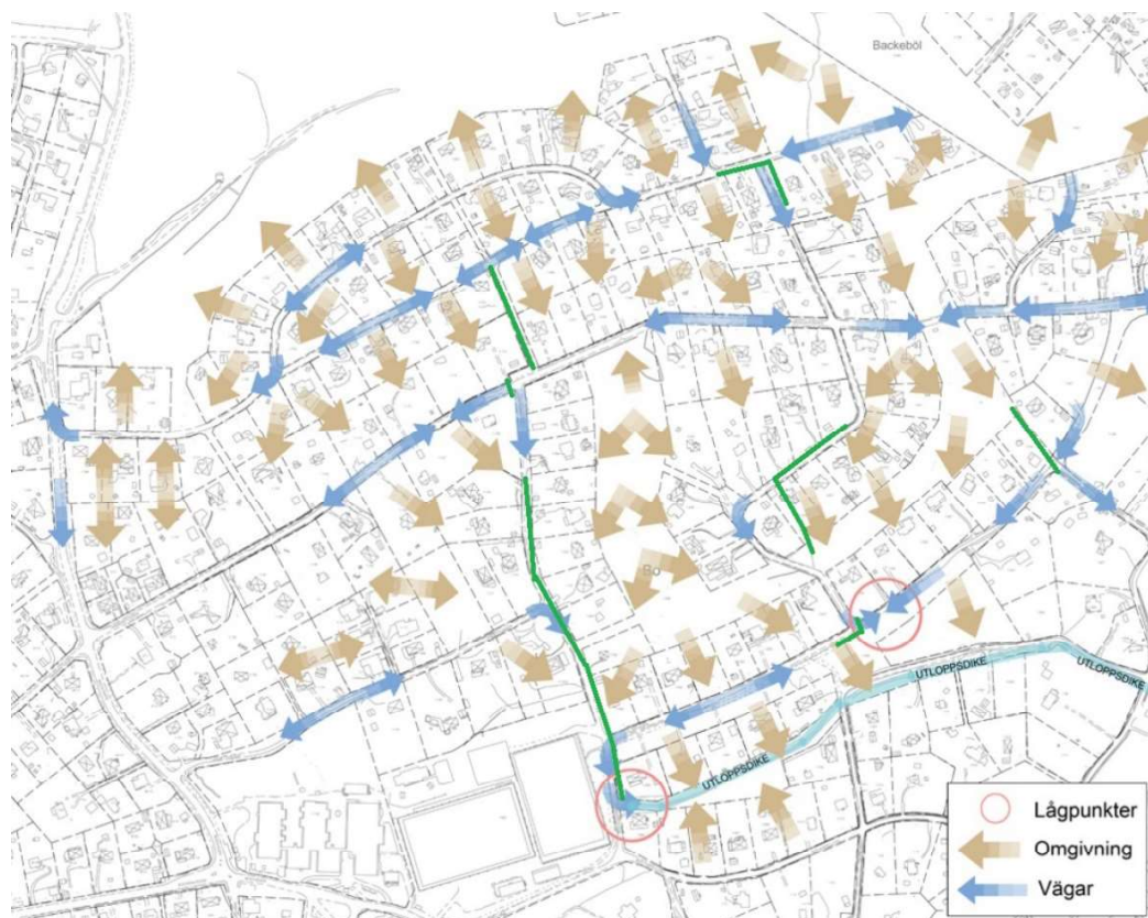
Figur 4. Uppskattad översikt av dagvattenflödet. Blå pilar visar flödesriktning för vägar och bruna pilar riktning för omgivning. Gröna linjer visar ungefärligt läge på befintliga dagvattenledningar.
