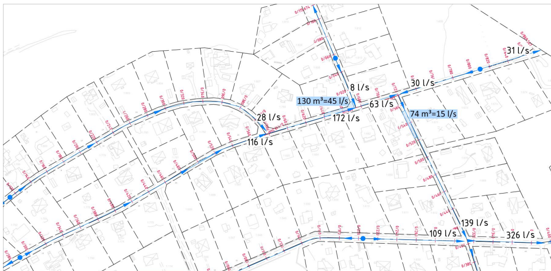
Figur 15. Östra Kornettvägen, med västlig och östlig avrinning. Blå punkt avser riktningssbyte.
