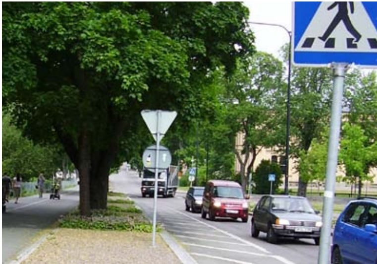
Växtbäddsrenovering av lönnar på kyrkogårdsgatan i Uppsala. Trädet på vänstra sidan har växtbäddsrenoverats 2006 och ytskikt av asfalt har bytts till ytor med luftigt grus och perenner i kombination. Trädet på högra sidan är lämnat utan åtgärd i yta av asfalt och stenmjöl. Trädet med renoverad växtbädd svarade omedelbart med förnyad vitalitet. (Foto: Örjan Stål)
