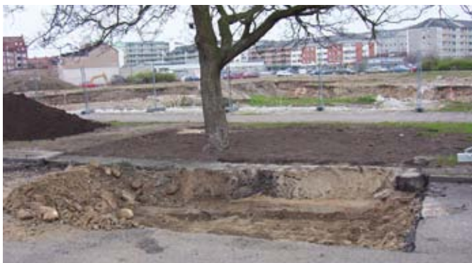
Provschakt i gata nära träd. Inga trädrötter har här påträffats i vägöverbyggnaden. (Foto: Örjan Stål)
