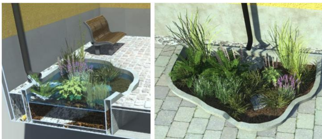
Figur 7. Illustration över öppen regnbädd med vegetation
