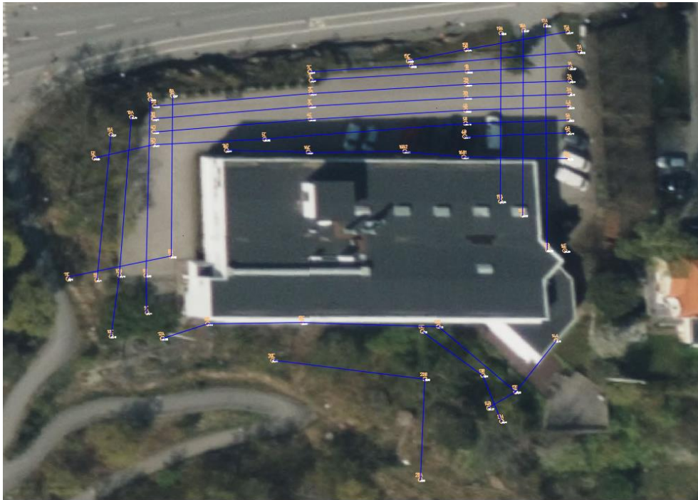
Figur 4: Markradarlinjerna inom undersökningsområdet. Bild från Microsoft Corporation 2022.
