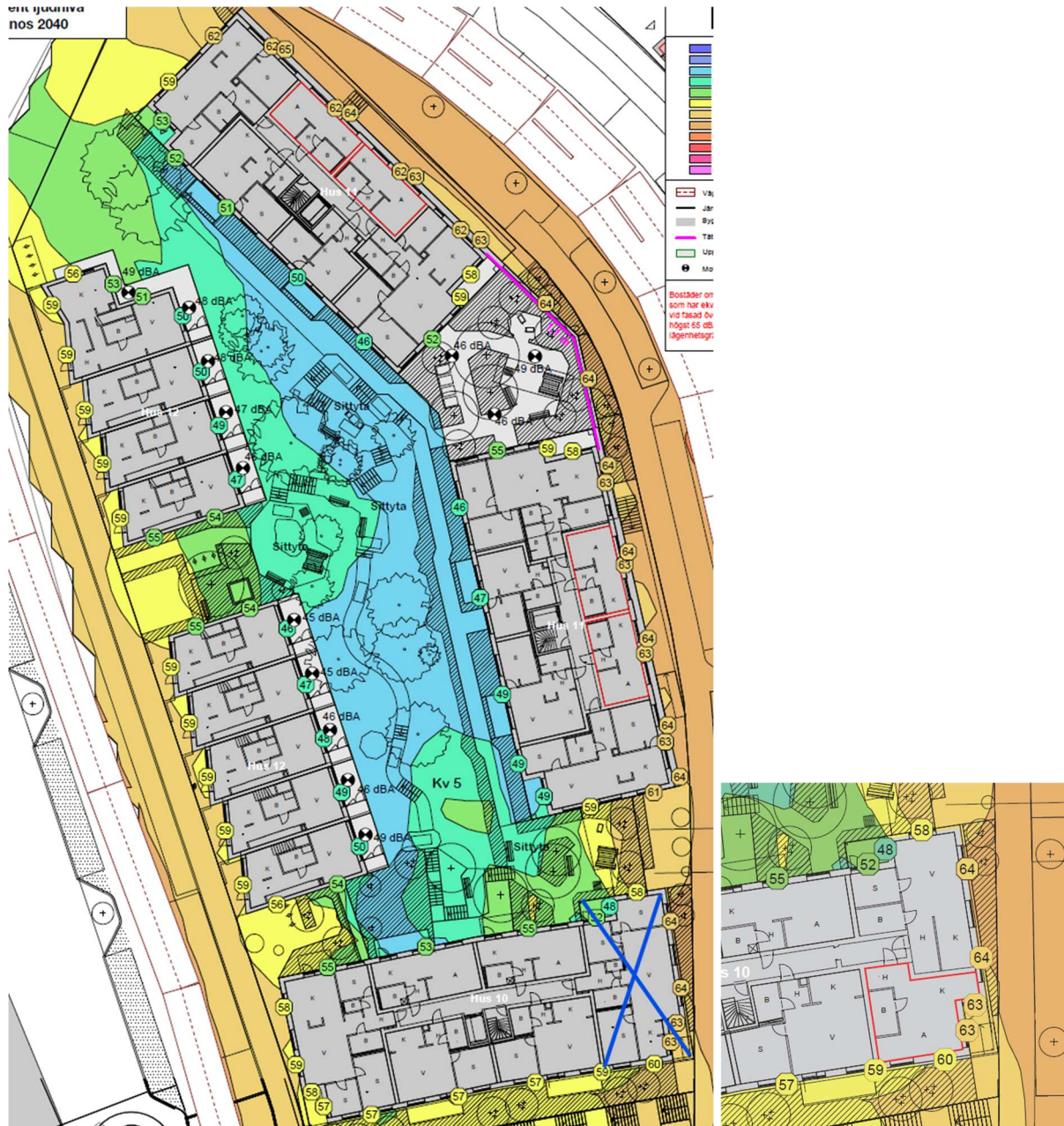
Figur 62. Till vänster: Dygnskvivalent ljudnivå från trafik vid kvarter 5. Prognos för år 2040. Cerise linje visar bullerskydd genom en 1,1 meter hög skärm och röda linjer bostäder om högst 35 kvadratmeter. Den östra lägenheten i hus 10 markerad med ett blått kryss, bedöms dock inte uppfylla bestämmelsen m_2 (ACAD, 2025). Till höger: Justerad planlösning som klarar riktvärdena genom att lägenheten i det södra hörnet är mindre än 35 kvadratmeter och den norra klarar hälften av bostadsrummen mot ljuddämpad sida. Planlösningarna ska endast ses som en möjlig utformning. (Ursprungsbild från ACAD, 2025 men med justeringar av planlösning gjorda av Nacka kommun, 2025)
