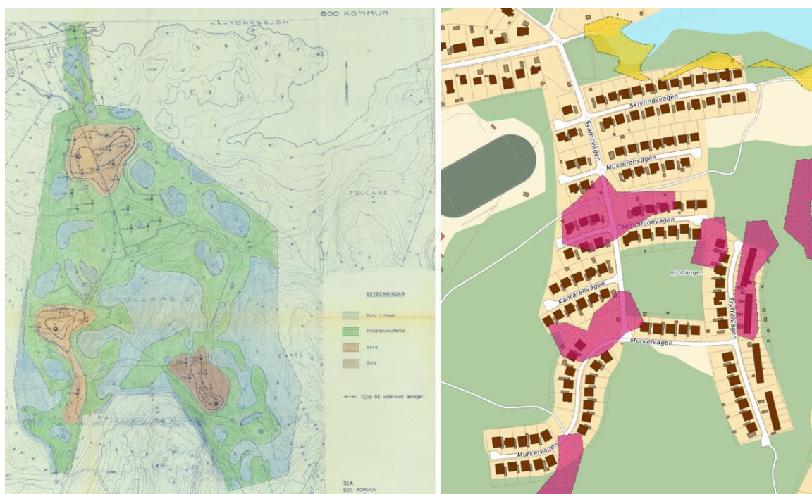
Figur 8. Till vänster: Bild ur översiktlig geoteknisk undersökning av området från år 1964. Berg i dagen (blå), friktionsmaterial som grus, sand, morän (grön), lera med överlagrad torr (brun). Till höger: Områden med förutsättningar för skred (rosa), respektive strandnära skred (gult) enligt SGU.
