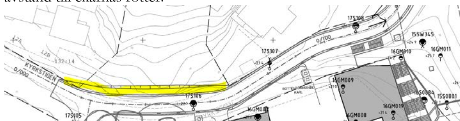
Del av Kyrkstigen som avses breddas till förmån för ledningsdragning som ska läggas med ökat avstånd till ekarnas rötter.
