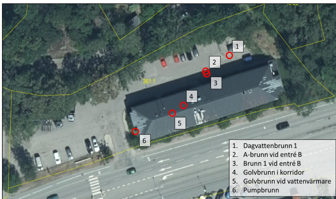
Figur 2. Placering av provtagningspunkter för kvicksilverspårning i slam (punkt 1) och vatten (punkt 2-6) inom Sicklaön 361:1. Gul linje markerar fastighetsgräns.
