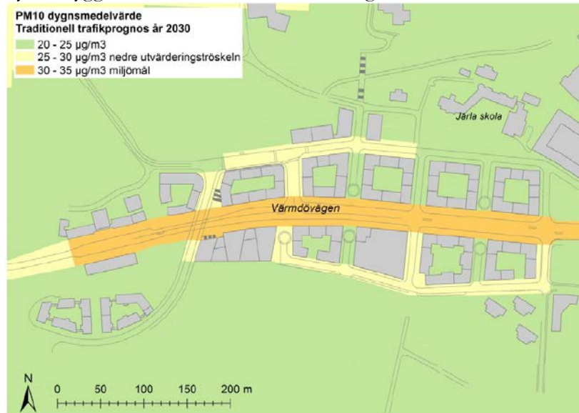
Figur 31. Beräknad dygnsmedelhalt år 2030 av partiklar, PM10 ( \mu\text{g}/\text{m}^3 ) under det 36:e värsta dygnet. Trafikprognos traditionell. Överskrider halten på kartan 50 \mu\text{g}/\text{m}^3 överskrider miljö kvalitetsnormen. Är halten på kartan större än 30 \mu\text{g}/\text{m}^3 klaras inte miljömålet.
