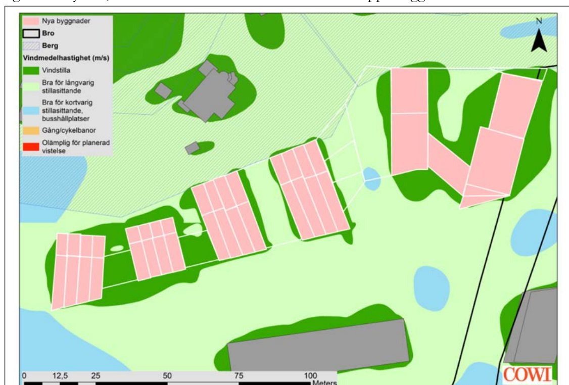
Figur 40. Vindkomfort för utomhusmiljön. Beroende på vindkomforten kan tre olika kategorier av vistelsemiljöer urskiljas. I kartan ovan framgår vilka ytor som ur vindsynpunkt lämpar sig för vistelse: områden lämpliga för långvarigt stillasittande (grönt), områden lämpliga för kortvarigt stillasittande/vistelse (blått). Analysen visar att Järla norr kommer få bra förhållanden för vistelse. Endast en liten del av det övre torget lämpar sig endast för kortvarigt stillasittande. I östra hörnet av det nedre torget ser det ut att bli helt vindstilla.
