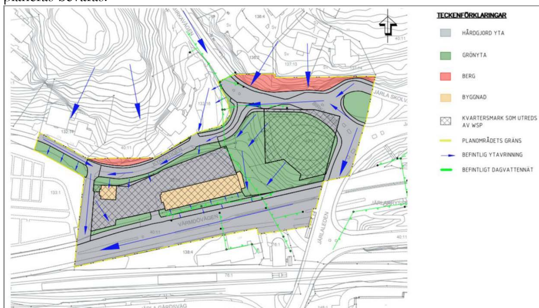
Figur 16. Befintlig markanvändning inom planområdet samt befintlig ytavrinning och dagvattennät inom området.
