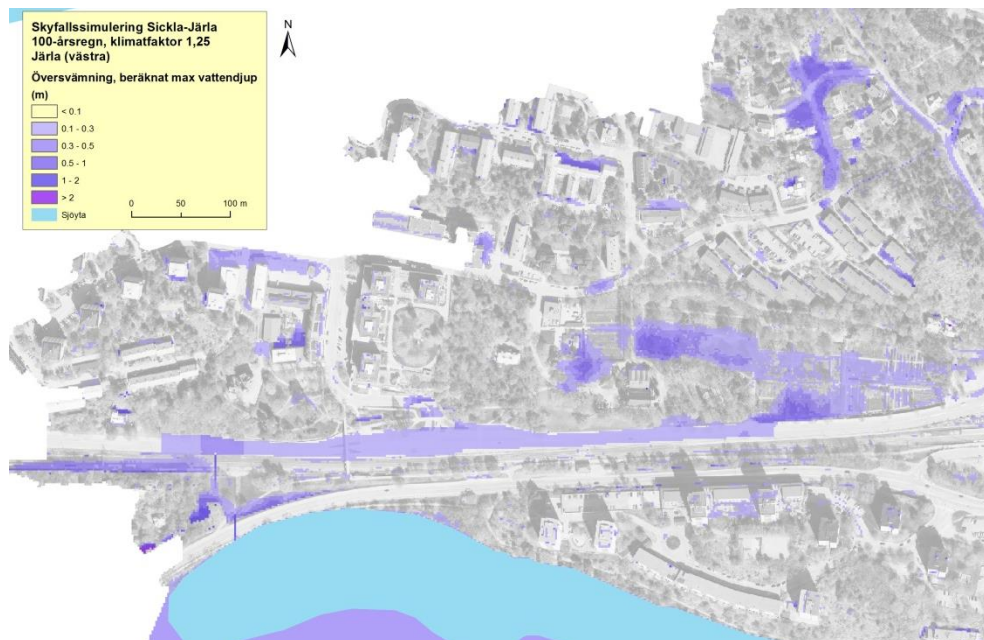
Figur 15. Beräknat maximalt översvämningdjup vid ett 100-årsregn med klimatafaktor 1,25 och reviderat höjdsättningsförslag.
