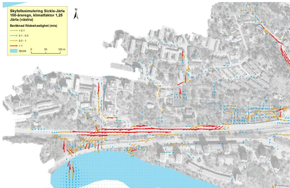
Figur 16. Flödesriktningar och flödes hastigheter. Pilarnas storlek är proportionell mot flödes hastigheten.
