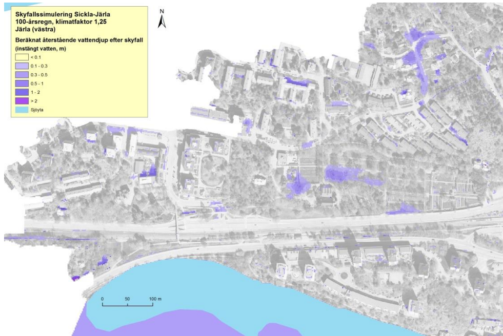
Figur 17. Beräknat återstående vattendjup efter skyfall.
