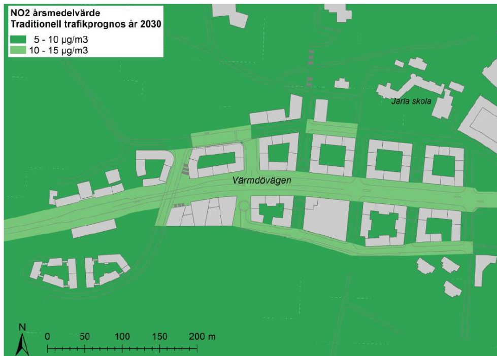
Figur 23. Beräknad årsmedelhalt av kvävedioxid, \text{NO}_2 ( \mu\text{g}/\text{m}^3 ) vid trafikprognos traditionell år 2030. Överskrider halten på kartan 40 \mu\text{g}/\text{m}^3 överskrider miljö kvalitetsnormen. År halten på kartan högre än 20 \mu\text{g}/\text{m}^3 klaras inte miljömålet.
