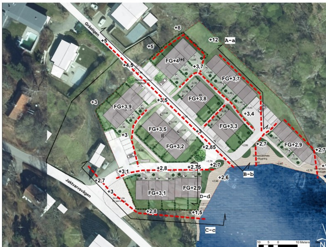
Figur 15. Konceptuell höjdsättning inom planområdet med streckning av låglinjer för hantering av skyfallsflöden genom att säkerställa sekundära rinnvägar (FG = Färdigt Golv).
