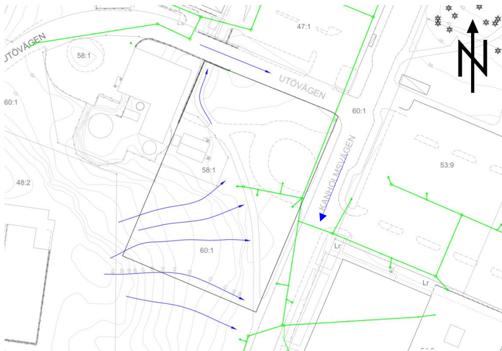
Figur 3. Nuvarande avvattning i utredningsområdet (blå pilar) och befintliga dagvattenledningar (gröna).
