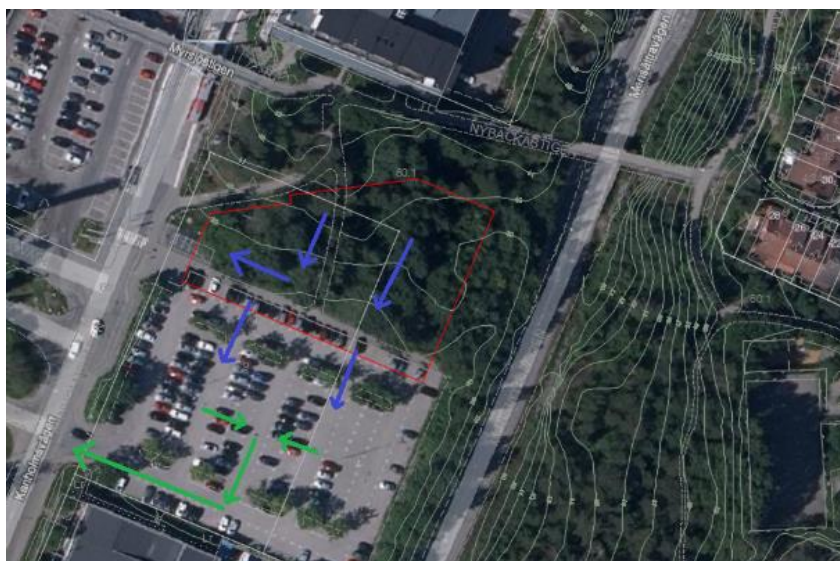
Figur 2. Ortofoto och höjdkurvor med uppdragsområdet inom röd linje. Blå flödespilar illustrerar ytvavrinningens riktning och de gröna pilarna flödesriktningen i dagvattenledningarna.
