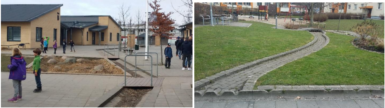
Figur 15: Exempel på hur rännalar för yttlig avledning.
