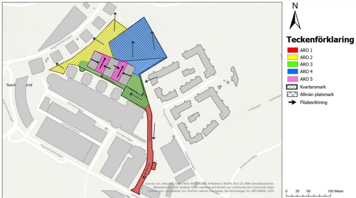
Figur 4-3: Delavrinningsområden, flödesriktning, allmän platsmark och kvartersmark för planerad situation.
