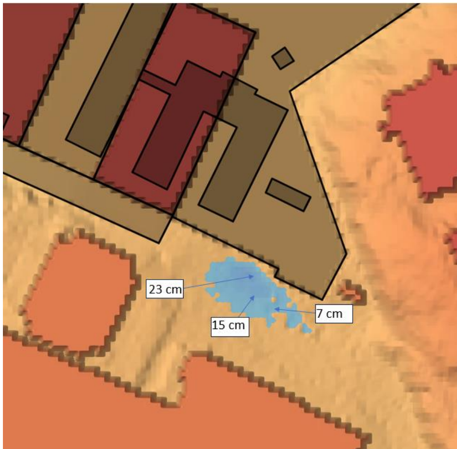
Figur 5-22: Inzoomad karta över lågpunkten och dess variationer på vattendjup. Observera att vattendjupen är ungefärliga och att planerad markanvändning är nedtonad för att illustrera lågpunkten (SCALGO Live, 2024).
