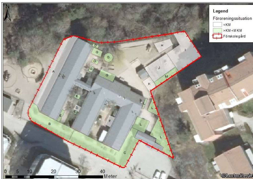
Figur 5-1 Föroreningsituation utifrån genomförd samlingsprovtagning, förorening och djup framgår av Tabell 5-1.
