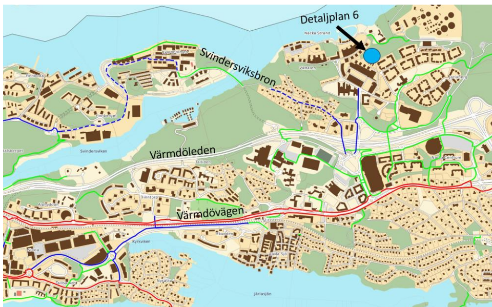
Figur 7. Karta över cykelnätet i Nacka Strands närområde. Blå heldragen linje är huvudcykelnät, blå streckad linje är huvudcykelnät i blandtrafik, röd heldragen linje är regionala cykelstråk, röd streckad linje är regionala cykelstråk i blandtrafik, grön heldragen linje är lokala cykelstråk och grön streckad linje är friliggande cykelvägar.
