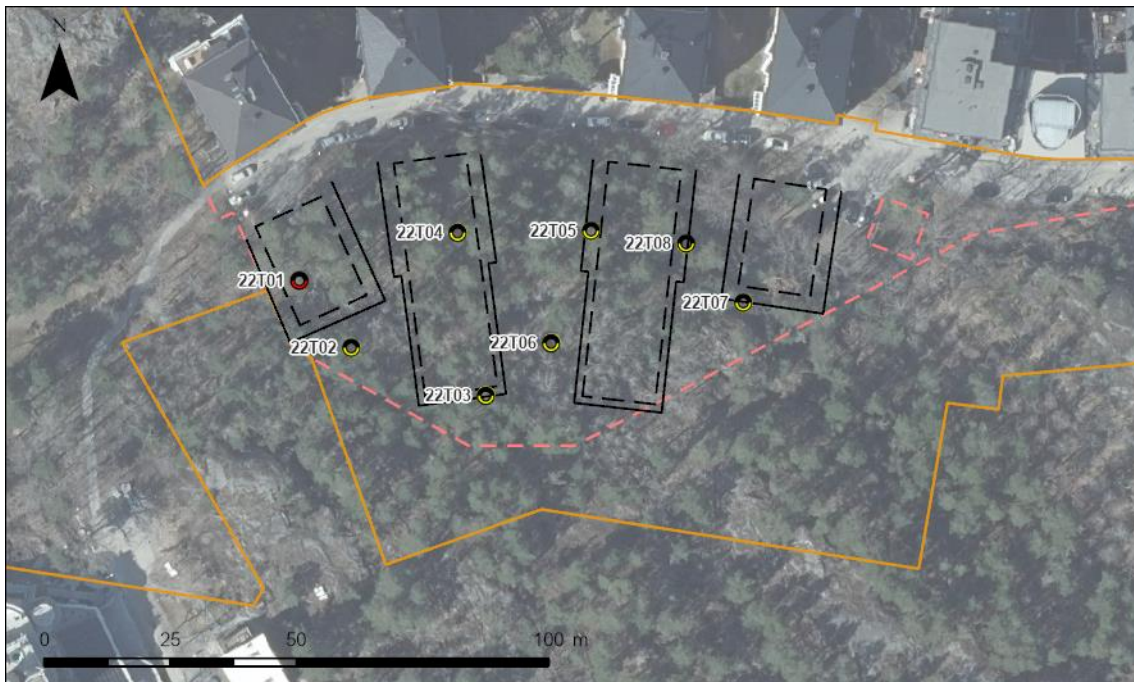
Figur 9. Streckade svarta linjer illustrerar ytor för planerade byggnader. Placering utförda provtagningspunkter med klassning enligt Naturvårdsverkets generella riktvärden, gul markering illustrerar halter över KM och lägre än MKM och rött halter över FA. Streckad röd linje markerar fastighetsgräns.
