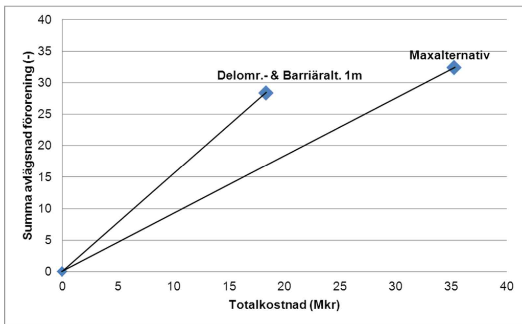
Figur 6. Summa avlägsnad förorening vid norra delen av Sicklaön 83:33 som en funktion av totalkostnaden för de olika åtgärdsalternativen. Se texten för en beskrivning av hur värdena har beräknats.
