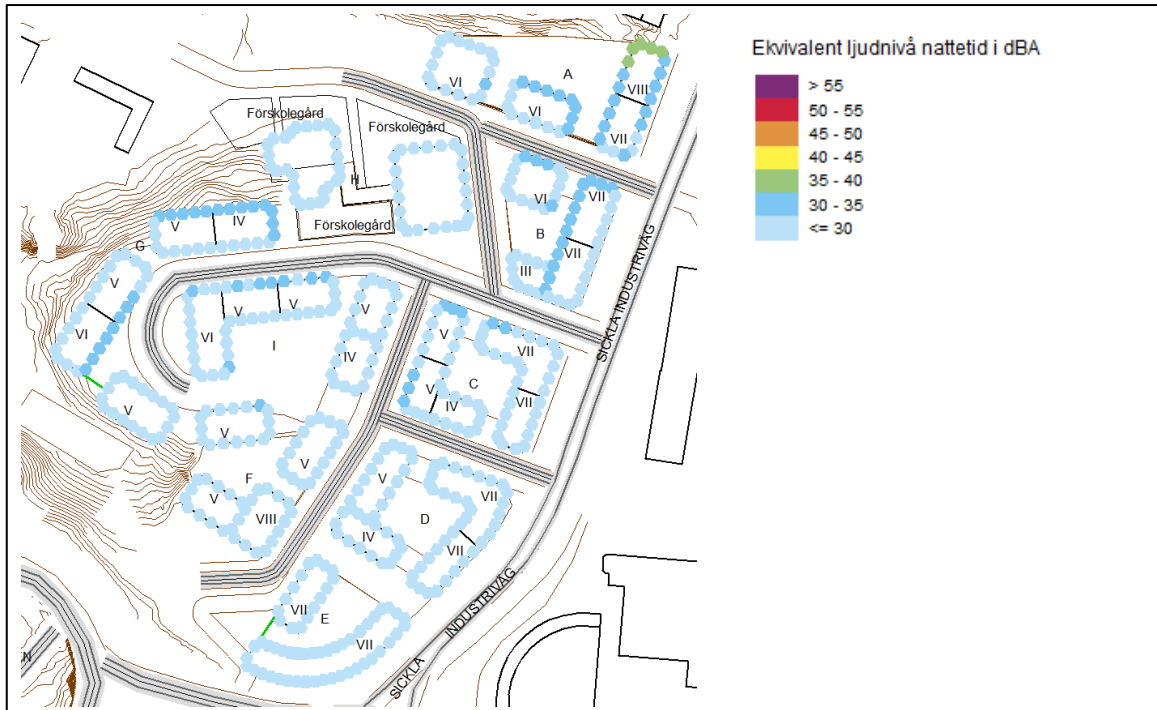
Figur 41. Högsta ljudnivån vid något våningsplan vid fasad från installationer på tak.
