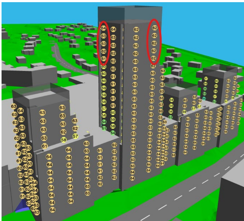
Figur 33: Bild som visar resultat av bullerberäkningar mot väster (Vikdalsvägen). Värdena visar ekvivalenta bullernivåer, dBA. Det inringade området visar de tio lägenheter där bullerriktvärdena inte klaras och där tekniska åtgärder krävs. (Bild: ACAD)
