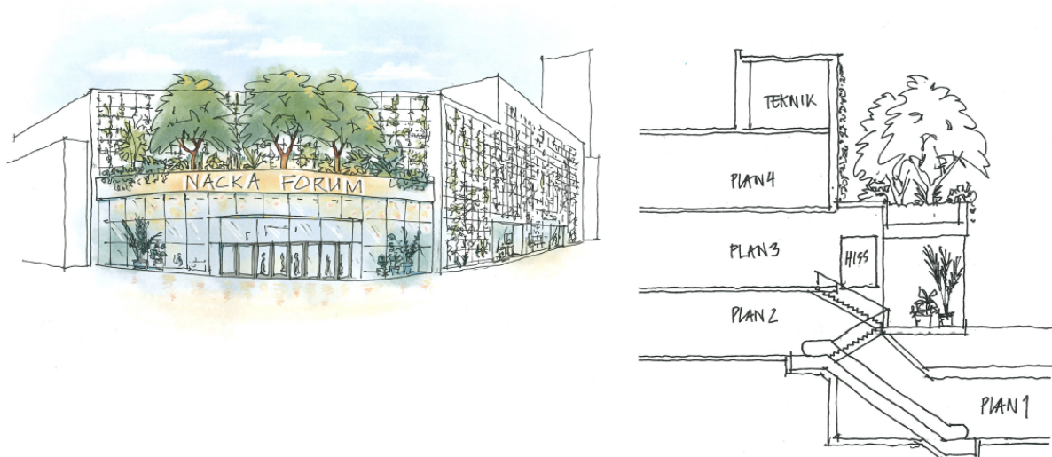
Figur 12. Konceptskiss som redovisar en möjlig utformning av en ny entré för Nacka Forum mot Skvaltans väg. Förbindelsetunneln ses i sektionen och detaljplanen möjliggör att tunneln kan anslutas centrumbyggnaden genom ett nytt trapphus med rulltrappor. (Bild: Koncept part of AFRY)
