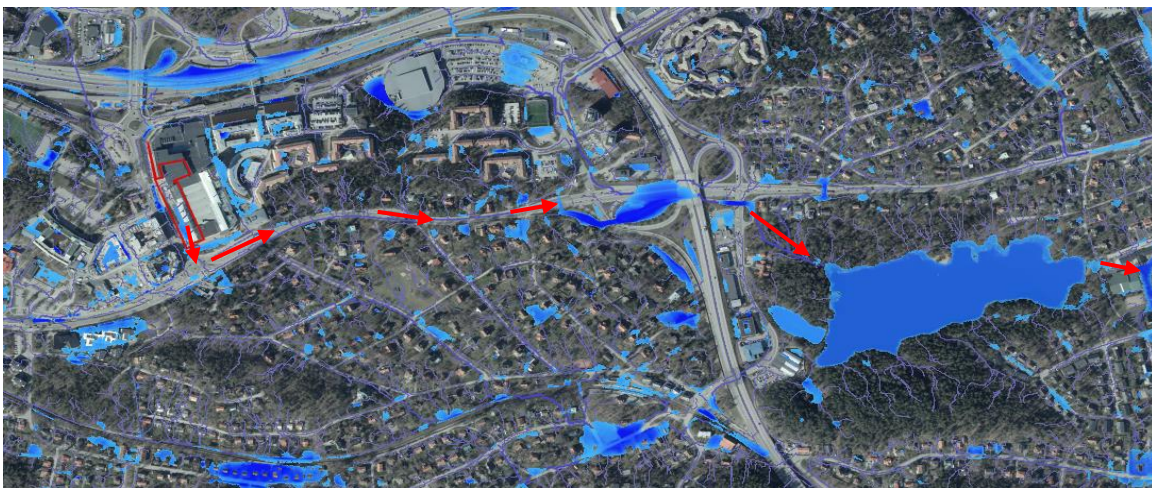
Figur 18. Överblickskarta över vattenansamlingar och huvudsakliga avrinningsstråk mellan planområdet och recipienten. Planområdet är utmarkerad med röd gräns. Förväntad väg från planområdet till recipienten är markerad med röda pilar. Detta är den alternativa vägen där vatten avrinner till Långsjön.
