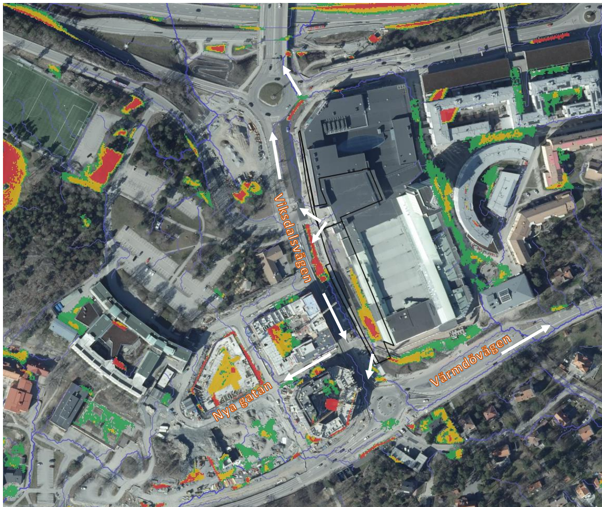
Figur 5. Huvudsakliga avrinningsstråk vid ett regndjup på 50 mm. Befintlig lastkaj utgör en lågpunkt. Plangränsen är utmarkerad med svart linje. Riktning på avrinning markeras med vita pilar.
