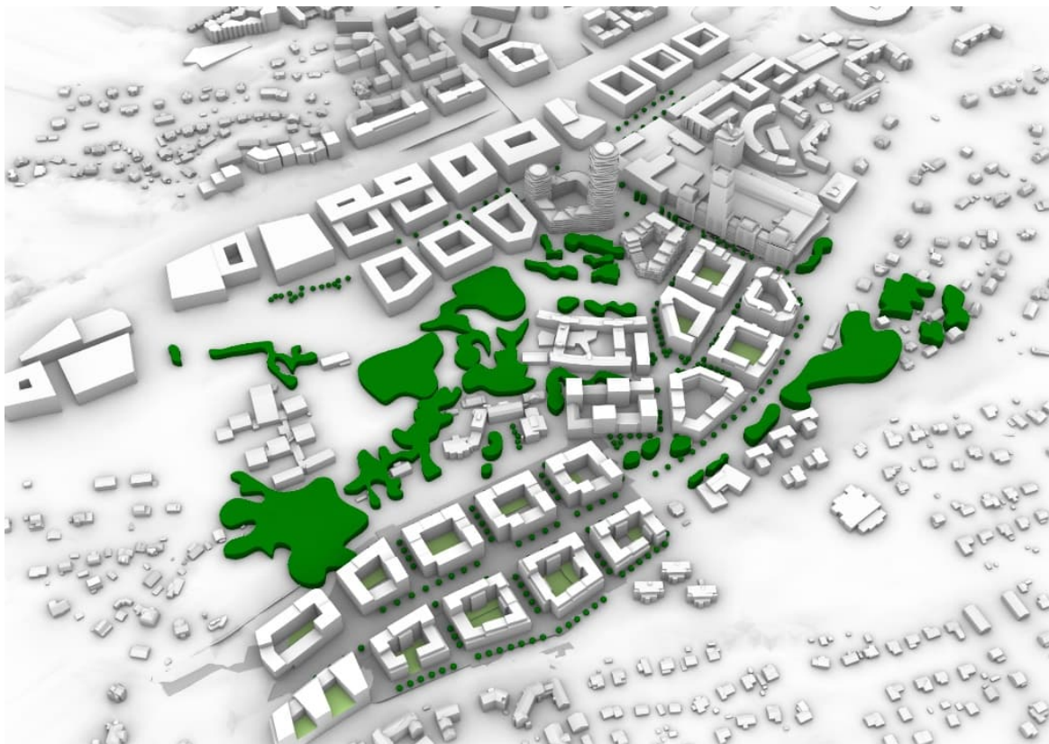
Figur 9. 3D-modell av träd med olika höjder som simulerats i Simscale.
