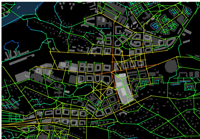
Figur 23. Denna rumsintegreringsanalys med Space Syntax visar väl integrerade gångstråk runt om hela kvarteret med möjlighet till de mest frekventerade gångrörelserna längs Vikdalsvägen. Ju varmare färger desto fler gångrörelser förväntas ske. Bilden visar framtida struktur.
