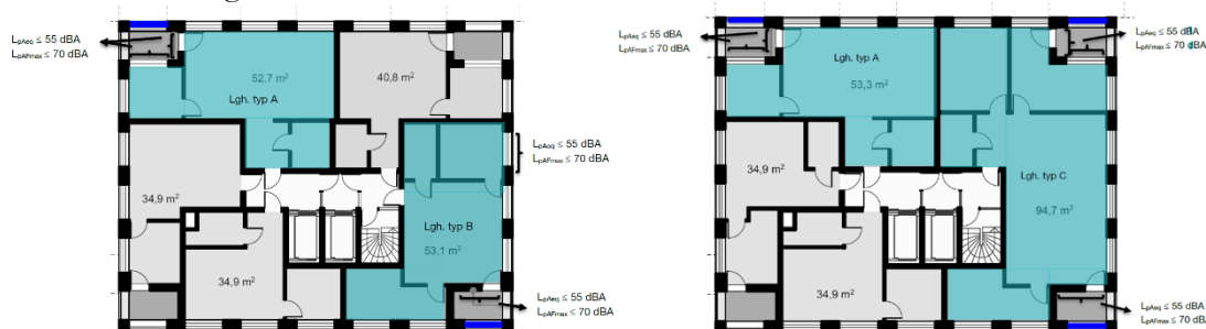
Figur 12. Exempel på lösningsförslag på loggia med en sida inglasad.
