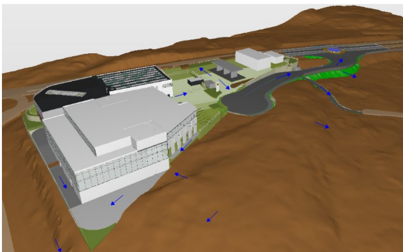
Figur 56: Skyfallsavrinning efter planerad exploatering, sett från sydöst.
