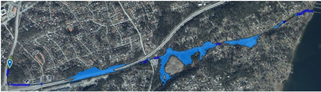
Figur 40: Sekundär avrinning från den västra delen av planområdet (Scalگو Live 2023-09-05).
