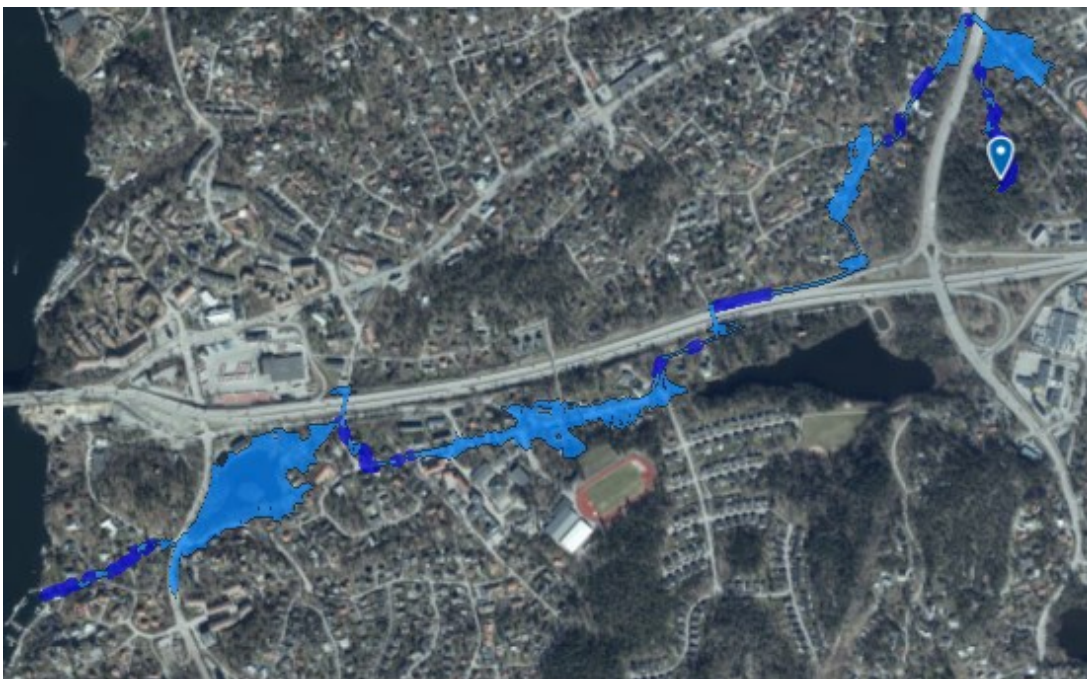
Figur 42: Sekundär avrinningsväg från den östra delen av planområdet (Scalگو Live 2023-09-05).
