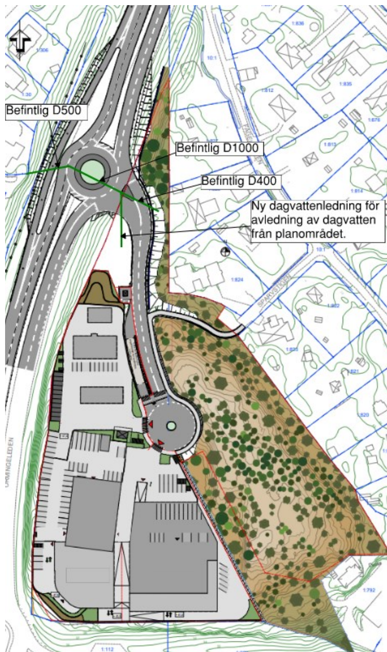
Figur 31: Avledning dagvatten från planområde efter planerad exploatering.
