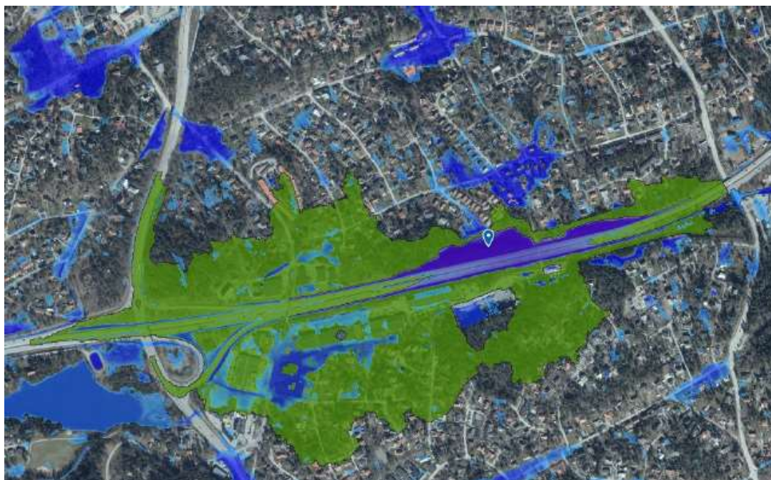
Figur 30. Mörkblå yta med positionsknapp visar lågpunkt på Värmdöleden. Gröna ytor utgörs av lågpunktens tillrinningsområde.
