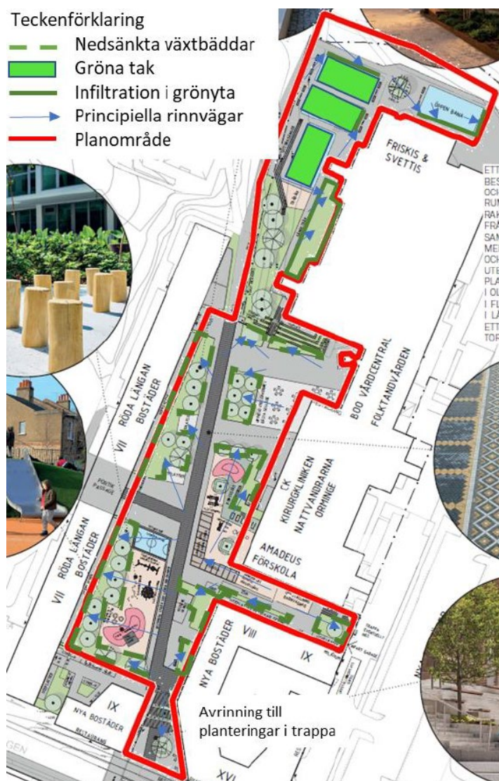
Figur 6. En översikt över föreslagen dagvattenhantering där planteringsytor nyttjas för dagvattenhantering.
