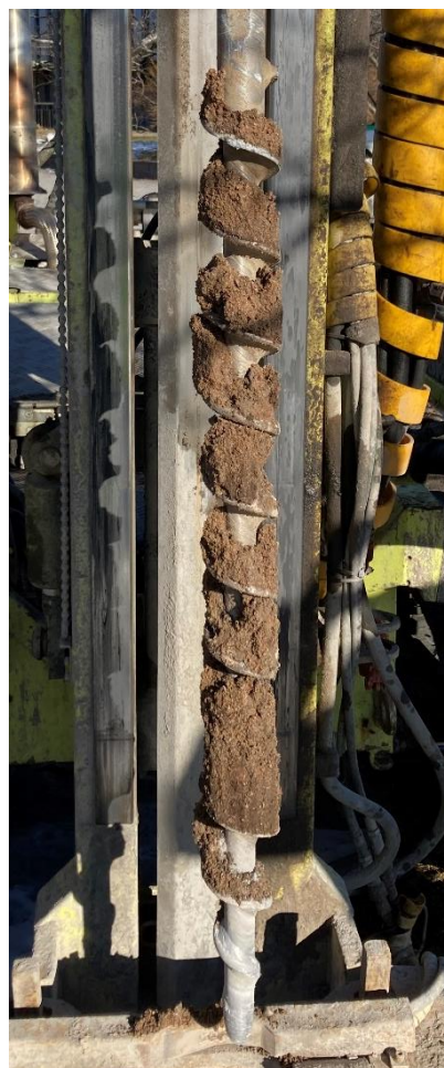
Figur 2. Skruv i provpunkt 22R18. Fyllnadsmaterialet bestod till stor del av grus och sand.
