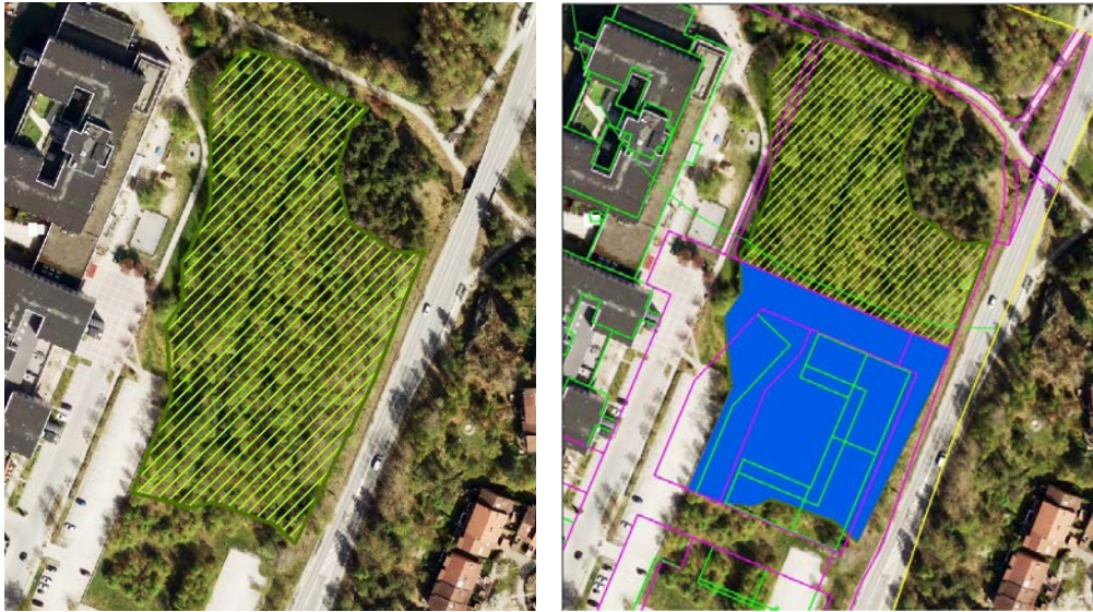
Sumpskogsområdet avgränsat av Calluna i tidigare naturvärdesinventering 2014 samt den yta som planeras att tas i anspråk. Blå yta är 5773 m 2 dvs den yta inom vattenområdet som fylls ut. Eftersom den överstiger 3000 m 2 bedöms utfyllnaden vara tillståndspliktig vattenverksamhet.
