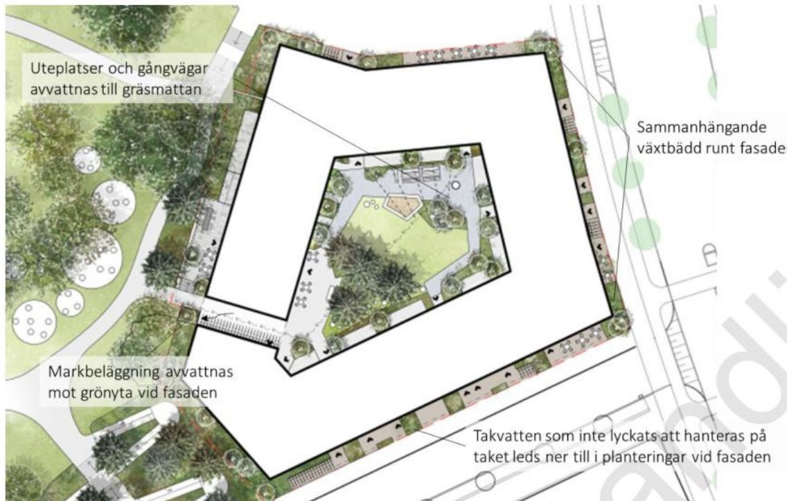
Figur 17. Förslag till dagvattenhantering på marknivån inom kvartersmarken (inom röd streckad linje), Urbio, 2023.
