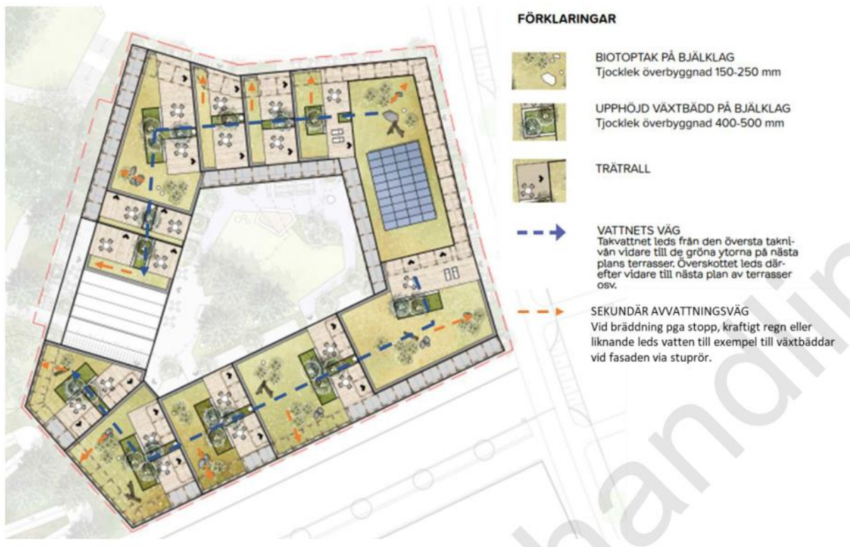
Figur 18. Förslag till dagvattenhantering på taket. Utredningsområdet gräns markerad med rött streckat linje, Urbio, 2023.
