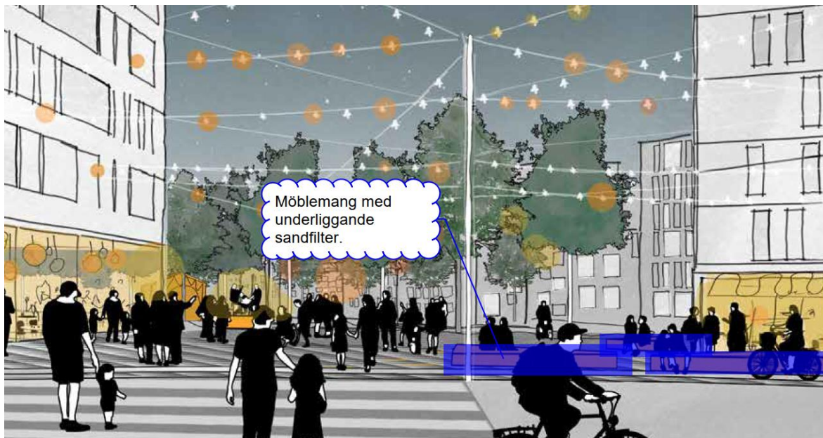
Figur 15. Läge för möblemang med underliggande sandfilter för fördröjning av dagvatten inom delområde C (illustration från Gestaltungsprogram Värmdövägen version 4 2021-03-01).
